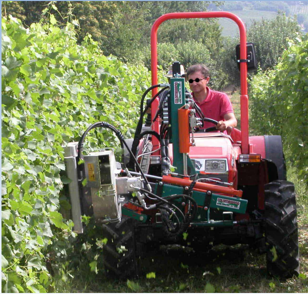
MACCHINA MONTATA SU TELAIO REVERSIBILE IN OPERA SULLA PARETE DX SU VITIGNO BARBERA
