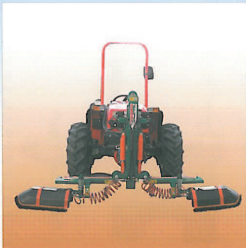
Barra diserbatrice frontale a quattro movimenti idraulici indipendenti
